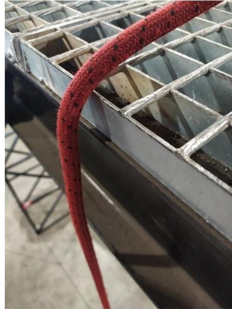
Se trata de la probabilidad de que un roce del sistema anticaídas contra los elementos estructurales dañe dicho sistema, de manera que se deteriore o llegue incluso a romper ciertos componentes del sistema.
