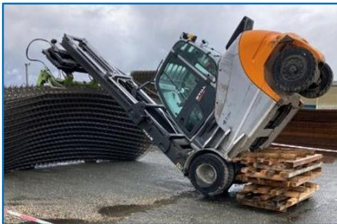
**UK** - El operador del montacargas estaba recogiendo una placa deslizante. Dio marcha atrás girando a la izquierda con la placa en las horquillas. Las ruedas rebotaron en un bache provocando que la horquilla derecha se rompiera e hizo que el plato cayera al suelo
