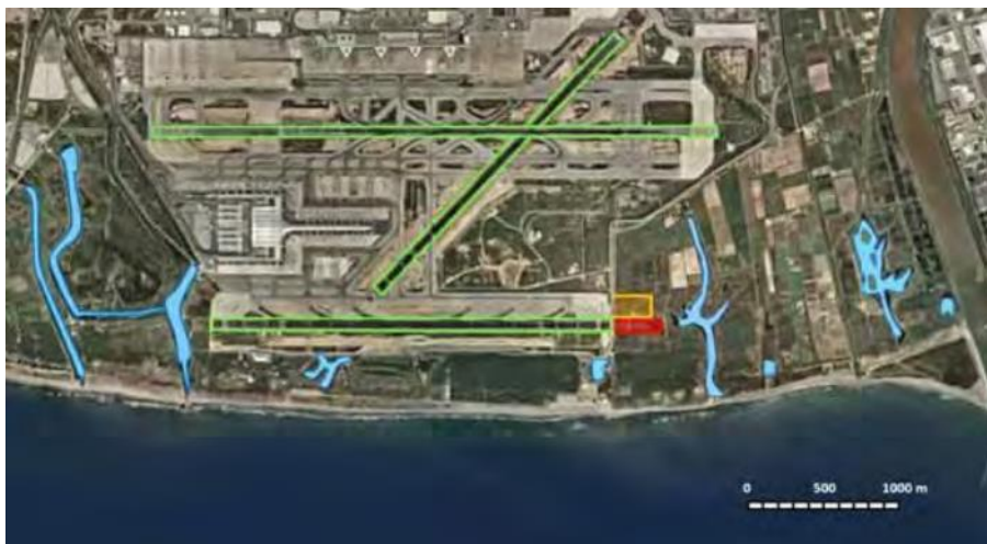
Figura 32. Opción de alargamiento de la pista corta a 300 metros. Font: Joan Rojas
