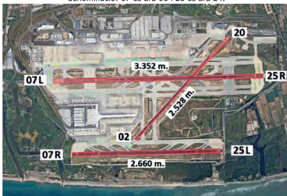
Figura 2. Situació de les pistes de l'aeroport de Barcelona. Font: IEC. Encara amb l'antiga denominació: 07 és ara 06 i 25 és ara 24.
