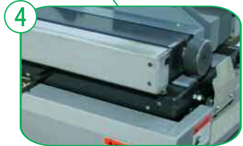
RESGUARDO FIJO EN LA ZONA DE PENSADO
