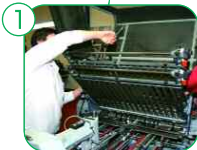
CUBIERTA ABATIBLE CON ENCLAVAMIENTO EN CORREAS DE TRANSMISIÓN
