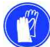
USO RECOMENDADO DE GUANTES DE SEGURIDAD ANTI-CORTE PARA LA MANIPULACIÓN DEL PAPEL, DE GROSOR FINO PARA NO MERMAR LA DESTREZA DEL OPERARIO.
