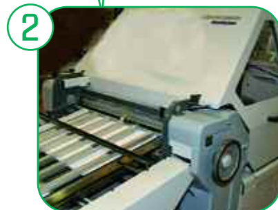
CUBIERTA ABATIBLE EN ZONA DE PLEGADO, CON DISPOSITIVO DE ENCLAVAMIENTO
