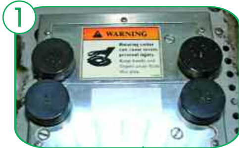
RESGUARDO MÓVIL MOTORIZADO EN LA ZONA DE FRESADO
