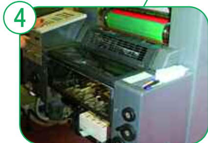
PROTECCIÓN TRANSPARENTE EN LA ZONA DE SALIDA
