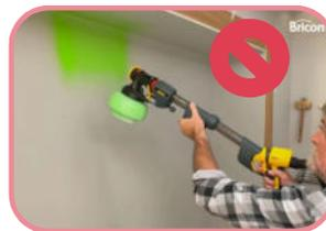
Pulverización fuera de la cabina con medidas de protección insuficientes.
