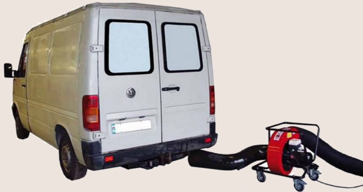
Quadre 4.5 Model de sistema d'extracció localitzada
